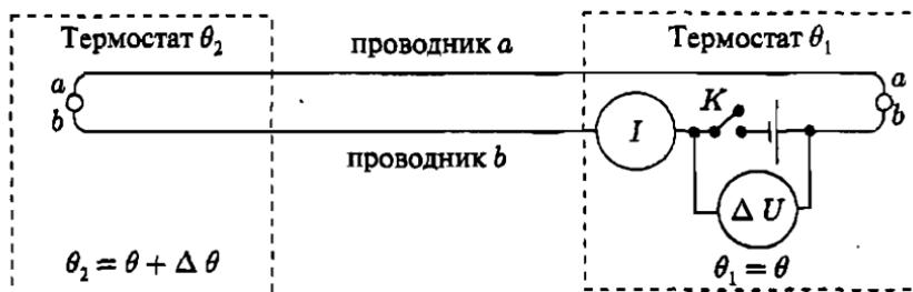
Рис. 3.3. Простейшая схема установки для наблюдения термоэлектрических явлений
